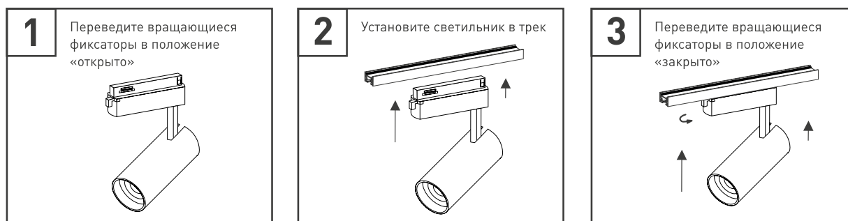
Рис. 3. Установка и подключение светильника
