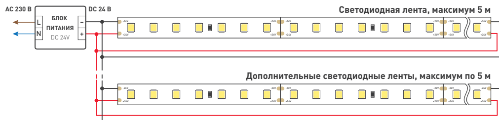
Рис. 2. Подключение нескольких светодиодных лент с двух сторон
