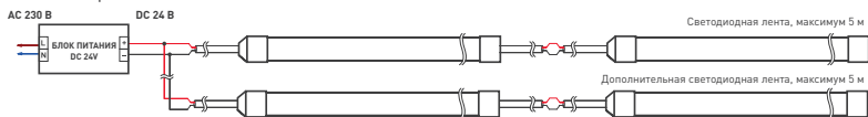
Рисунок 1. Схема подключения лент к источнику питания при температуре окружающей среды менее +40 °С
