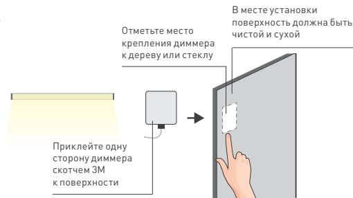
Рис. 2. Установка диммера SR-PRIME-UP
