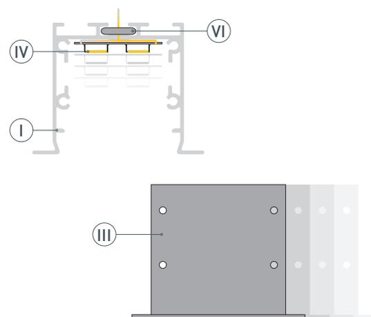
\* При установке соединителей на боковые стенки профиля необходимо закручивать винты с минимальным усилием, до первого ощущения сопротивления.
